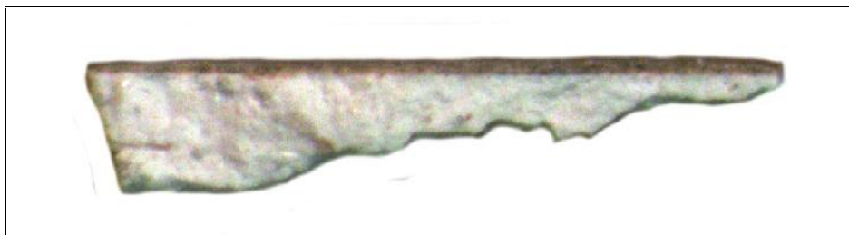
Рис. 32. Поперечный срез пробы 1( шлиф №1). Ярославль. Церковь Николы Надеина. Благовещенский придел, паперть. Северная стена. Поперечный срез живописного слоя с грунтом.
