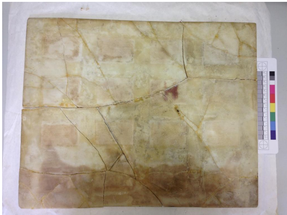
Рис. 3. «Кесарю кесарево», общий вид оборотной стороны после удаления деструктированного поролона. Клеевые швы потемнели, многочисленные фрагменты расклеились или раскололись по новым разломам в результате повреждения плиты.
