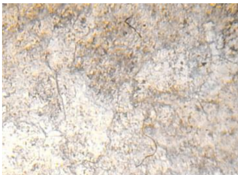
Рис. 1. «Натюрморт с виноградной гроздью». Микрофотография поверхности плиты с загрязнениями. Снимок в отраженном свете, стереомикроскоп EZ 4 D, Германия.
