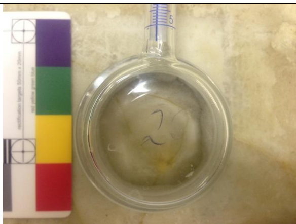
Рис. 4. На фрагменте №1 трубка Карстена установлена на области склейки.
